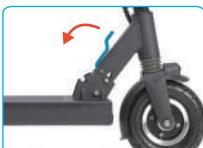
Posez un pied sur la plateforme. Avec votre main gauche poussez le mât vers l'avant et de la main droite tirez la poignée de pliage vers vous afin de replier le mât sur la plateforme.
