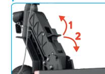
Posez un pied sur la plateforme. Soulevez la sécurité de la poignée de pliage vers le haut puis avec votre main gauche poussez le mât vers l'avant et de la main droite tirez la poignée de pliage vers vous afin de replier le mât sur la plateforme.
